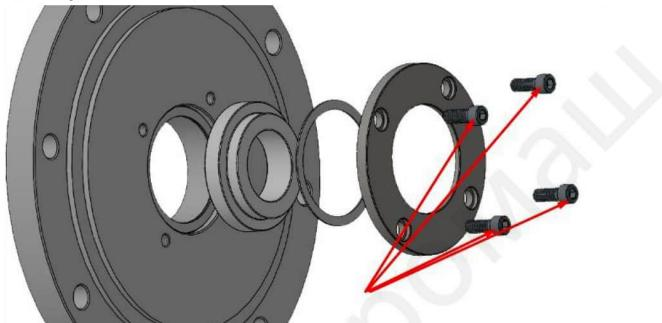
15.7.3 Соединить рабочее колесо (4) и крышку торцевого уплотнения (5), насадить сильфон (9) на вал рабочего колеса (4).
