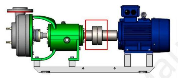
15.7.11 Проверить вращение рабочего колеса (4), колесо должно вращаться с небольшим усилием.
