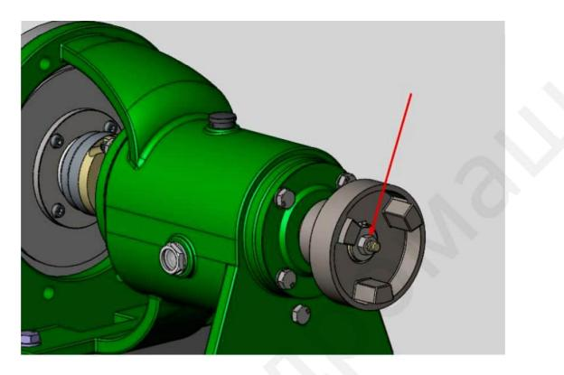
15.6.4 Снять рабочее колесо в месте с крышкой насоса и торцевым уплотнением.
