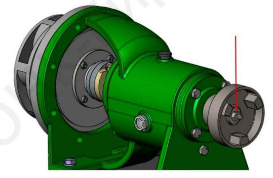
15.7.6 Установить корпус насоса в вертикальное положение ка показано на рисунке.
