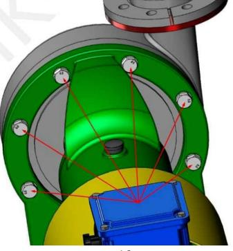
15.6.2 Снять корпус насоса (3).
