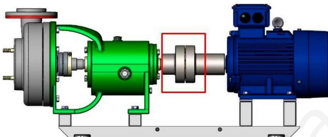
15.7.11 Проверить вращение рабочего колеса (4), колесо должно вращаться с небольшим усилием.
