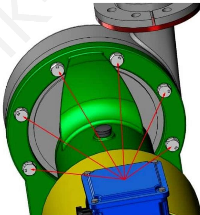
15.6.2 Снять корпус насоса (3).
