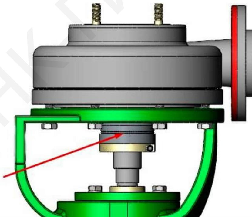
15.7.10 Установить насос на прежнее место, отрегулировать соосность муфты и затянуть болты опорного кронштейна к раме.
