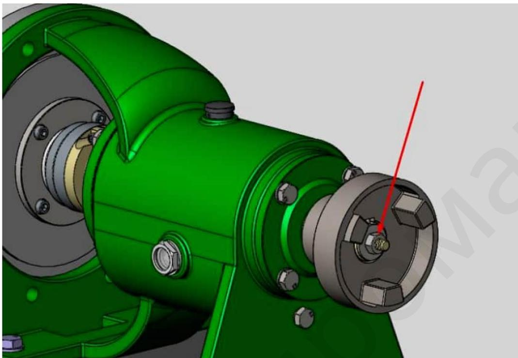
15.6.4 Снять рабочее колесо в месте с крышкой насоса и торцевым уплотнением.
