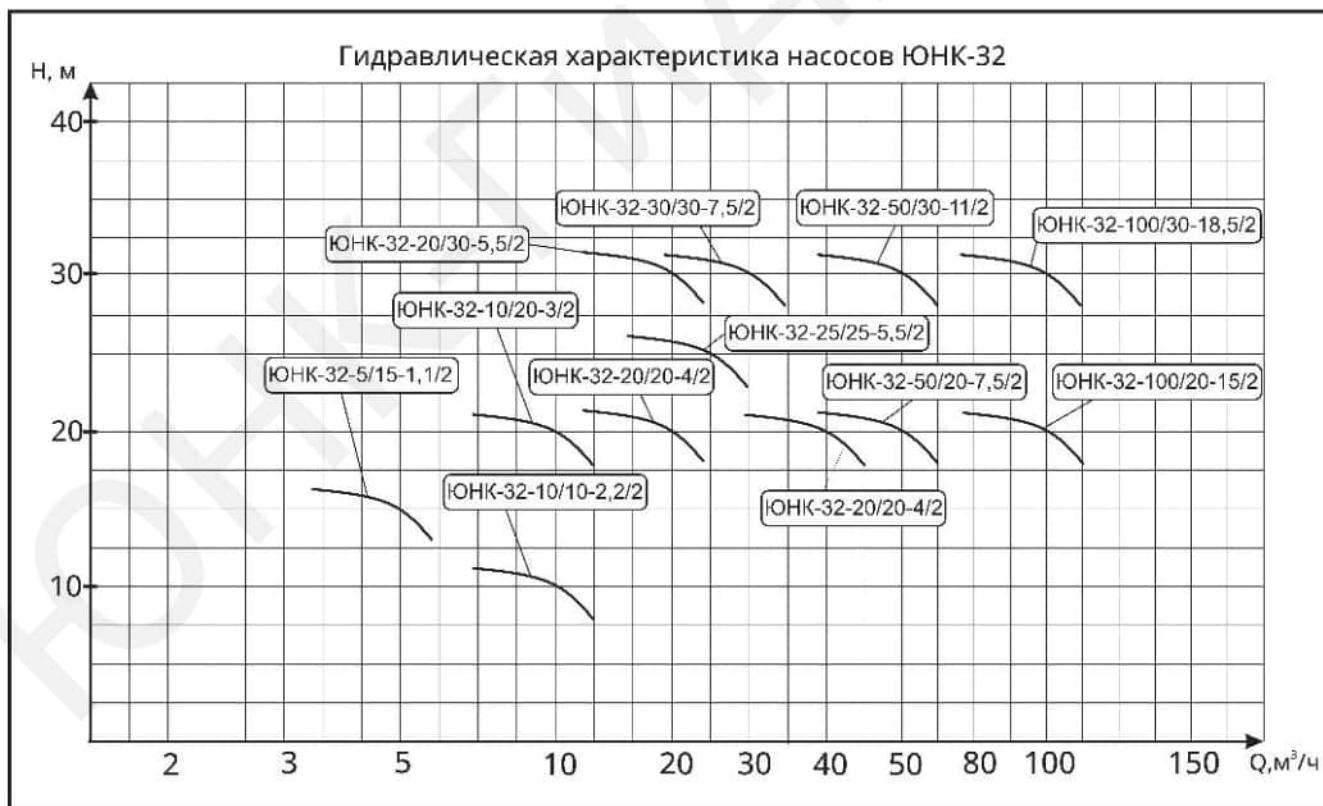
Значения напора и мощности действительны для жидкостей с плотностью 1000 кг/м³ и кинематической вязкостью  $\nu = 20$  мм²/сек.
