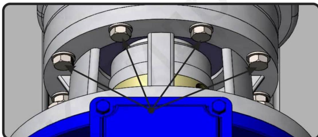
15.4.6 Снять корпус насоса (3).
