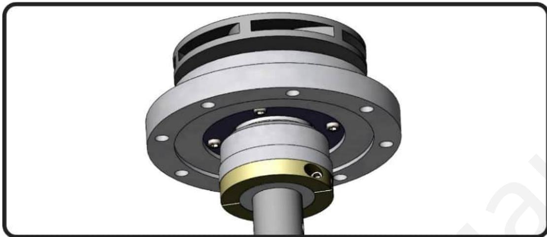
15.5.3 Установить рабочее колесо (4) на прежнее место фиксации на валу электродвигателя (12).
