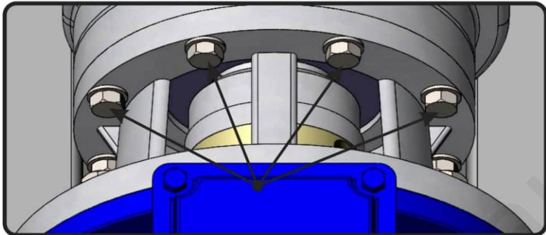
15.4.6 Снять корпус насоса (3).
