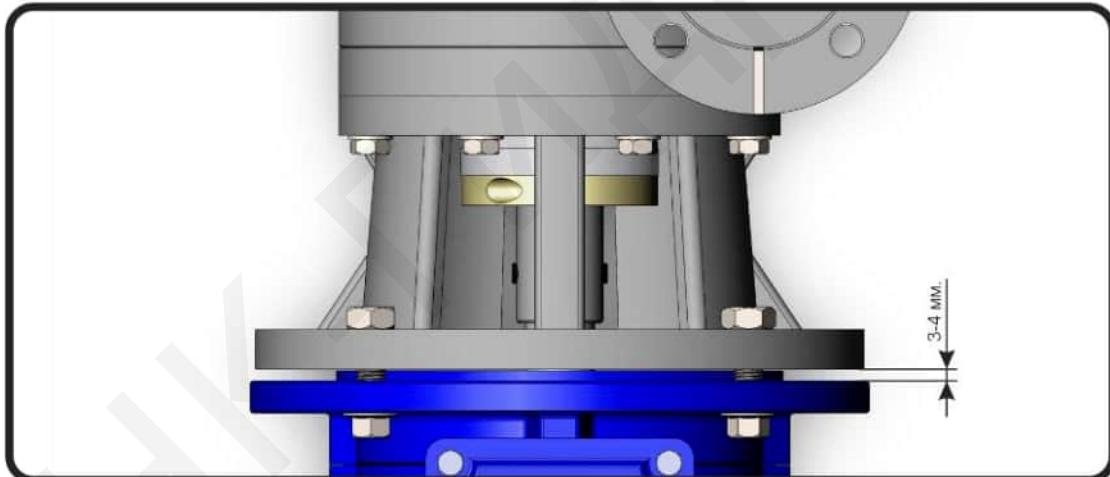
15.5.7 Затянуть болты полумуфты сильфона (10), для фиксации на валу;
