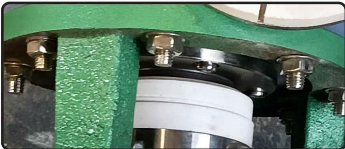
14.3 Периодически (не реже одного раза в сутки) следить за: показаниями приборов, герметичностью соединений, утечками через торцевое уплотнение, нагревом подшипниковых узлов.
